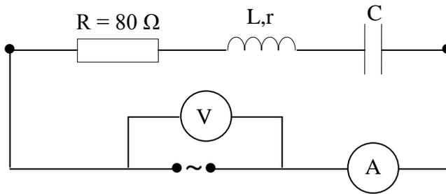
La valeur efficace  $U$  de la tension aux bornes du GBF est maintenue constante et égale à  $1\text{V}$  au cours de l'expérience. Les mesures relevées ont permis d'obtenir la courbe d'intensité  $I$  (mA) en fonction de la fréquence  $N$  (Hz) (voir feuille annexe).
